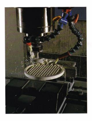
Zum Ausbrechen sollte mindestens 0,13cm (0,05 in) zusätzlicher Werkstoff auf der Rückseite vorgesehen sein. Dieser Überschuß kann nach dem Bohren entfernt werden.
